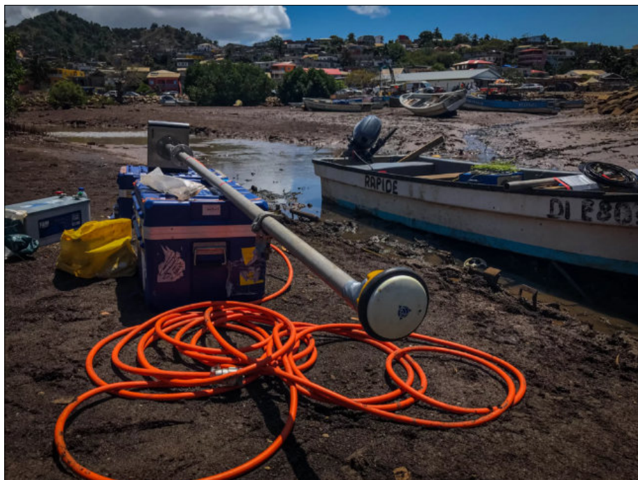
Ce sondeur de sédiments sera immergé à une vingtaine de centimètres en dessous de la surface. La complexité de cette cartographie portuaire de Mtsapéré étant la faible profondeur allée à des obstacles plus ou moins invisibles, notamment les déchets et racines de mangroves. Pour naviguer et mesurer ces fonds, une personne de l'équipe est bien souvent obligée de se mettre à l'eau.
