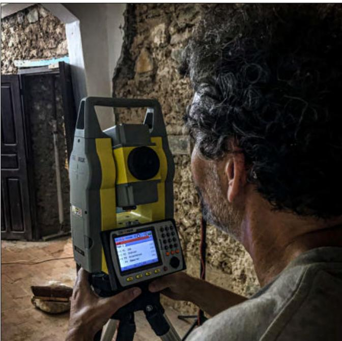
*Le géomètre Olivier Onezime est un passionné du Monde médiéval arabe. Il est en charge de procéder à tous les relevés des différentes structures et réalisera une photogrammétrie du site après nettoyage et découpage des murs. En sommes une vue 3D et précise de l'ensemble*
