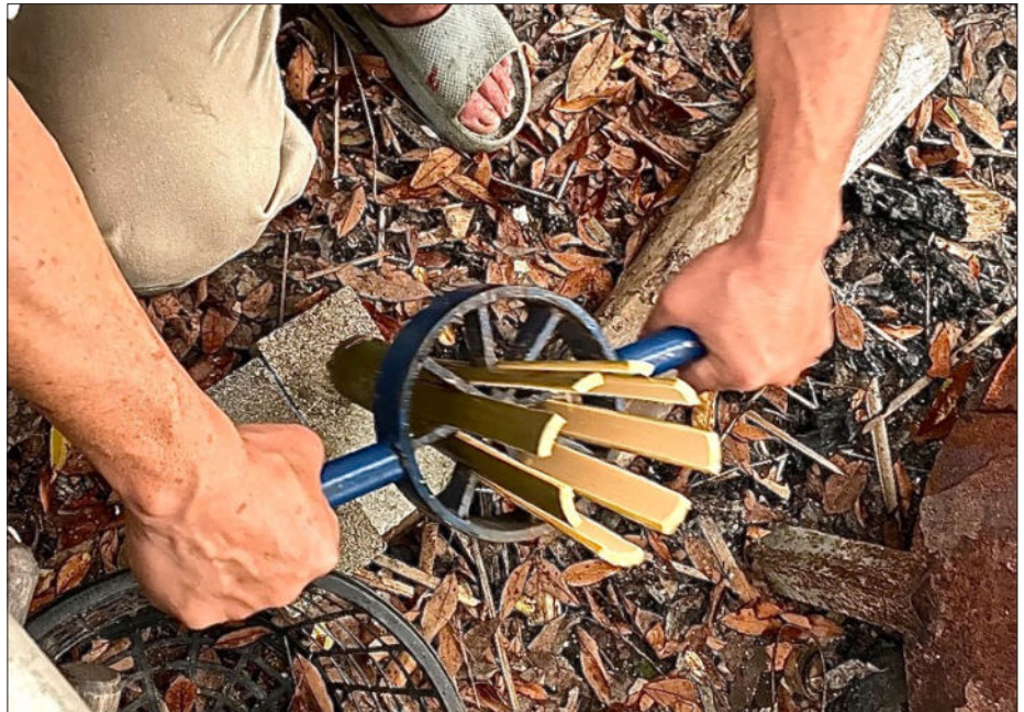
Découpe manuelle de lames de bambou à Taïwan (Photo : APL)
