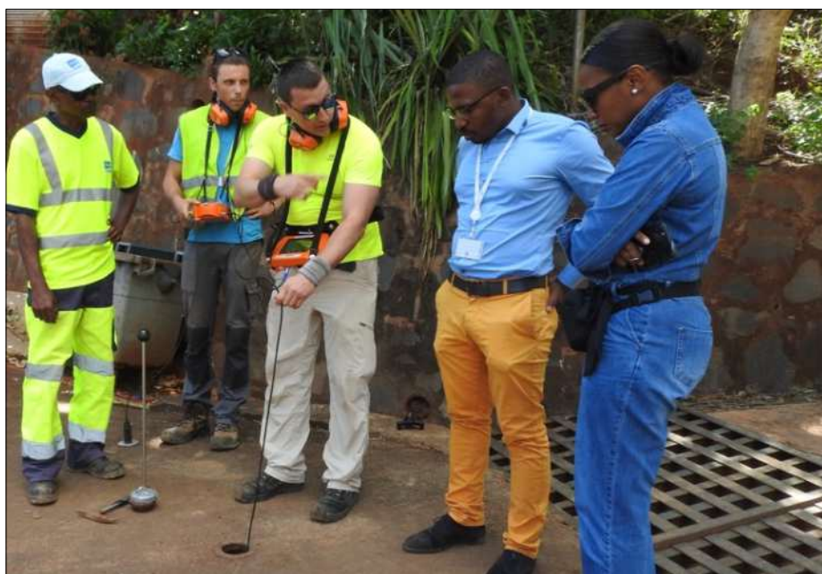
Il y a un an et demi, détection des fuites par la société Ax'eau
